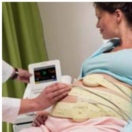
Avalon FM20 und FM30 ermöglichen die Überwachung von Drillings – dank einer modernen Dreikanal-Ultraschallerfassung und der Koinzidenzprüfung aller Herzfrequenzen.
