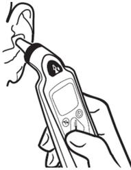
Das Ergebnis dieser Messung kann automatisch so umgerechnet werden, dass es der Temperatur an einer anderen Stelle des Körpers entspricht. Das Ergebnis wird auf dem Display des Thermometers angezeigt und an den Monitor übertragen.
