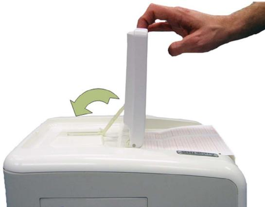
Bei einer Wandmontage des Monitors sollte der Bildschirm flach eingeklappt werden.
