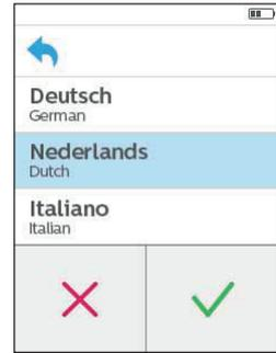
6. Wird die Sprachauswahl bestätigt, wird der Bildschirm neugestartet, und das Gerät kehrt zum Startbildschirm zurück. Die auf dem Bildschirm angezeigten Meldungen werden jetzt in der soeben ausgewählten Sprache angezeigt.
