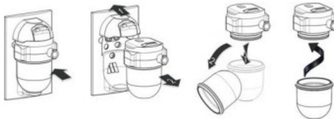
Abbildung 1.6 – Entleeren des Wasserabscheiders
