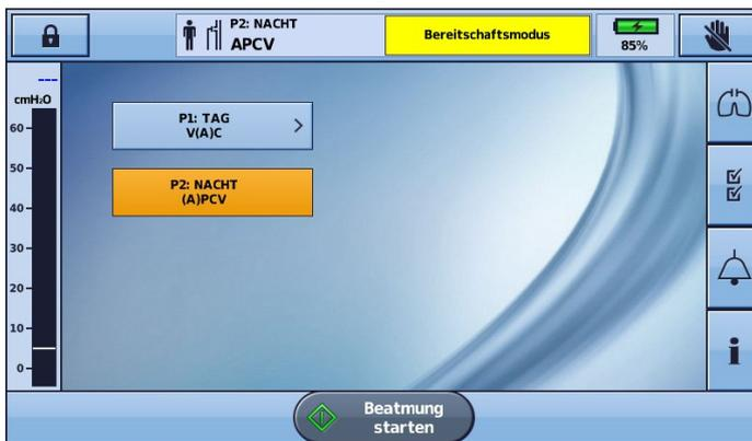
**Hinweis:** Um zu einem Beatmungsprogramm mit einem anderen Schlauchsystemtyp zu wechseln, müssen Sie die Beatmung stoppen. Sie können die Beatmung wieder starten, wenn Sie Schlauchsystem und Beatmungsprogramm gewechselt haben.
