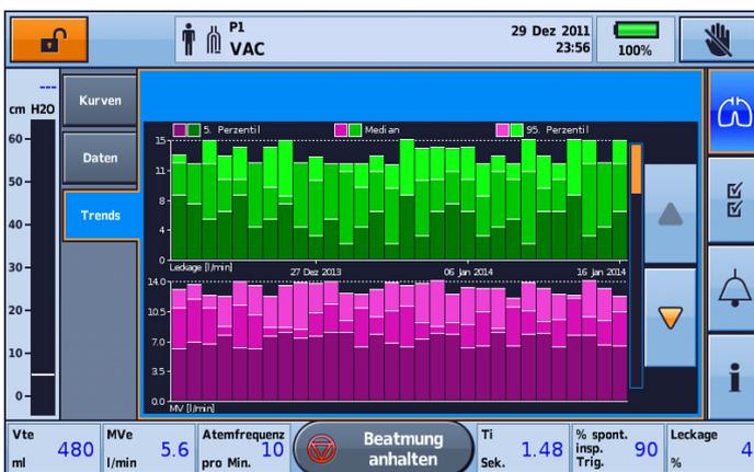
Die Informationen werden als Balkendiagramm mit zwei Diagrammen pro Bildschirmseite angezeigt. Nutzen Sie die „Nach oben“- und „Nach unten“-Scrollpfeile, um durch die Diagramme zu navigieren.
