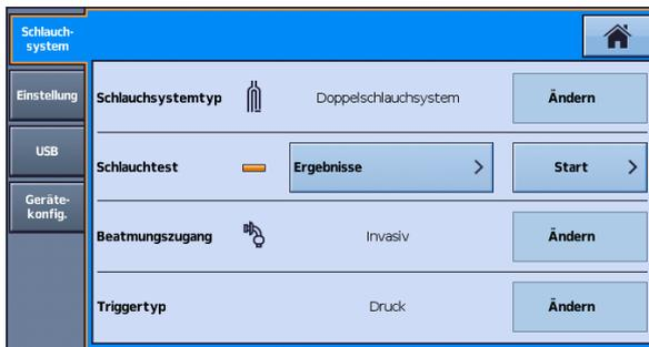
**Hinweis:** Der Triggertyp legt fest, ob ein druckbasierter Trigger-Schwellenwert oder ein flowbasierter Trigger-Schwellenwert verwendet wird, wenn ein Doppelschlauchsystem ausgewählt ist.
