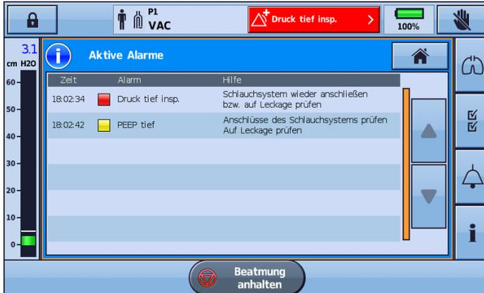
2. Drücken Sie auf **Alle zurücksetz.**, um mehrere Alarmer zurückzusetzen. Es werden nur diejenigen Alarmer zurückgesetzt, für die dies zulässig ist. Eventuell verbleibende Alarmer bedeuten, dass der Benutzer korrigierend eingreifen muss.
