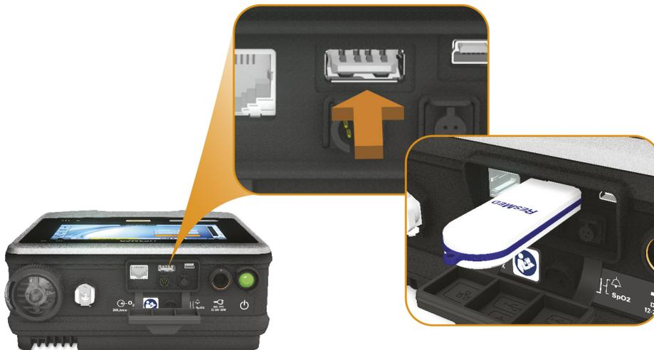
Um den USB-Stick zu entfernen, können Sie ihn nach dem Abschluss der Datenübertragung einfach aus dem USB-Anschluss ziehen. Falls zu diesem Zeitpunkt Daten übertragen werden, macht eine Meldung in der oberen Informationsleiste Sie darauf aufmerksam, dass die Datenübertragung fehlgeschlagen ist.
