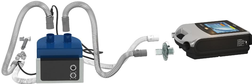
Bei Befeuchtung mit erwärmtem Wasser und einem Doppelschlauchsystem kann sich im Expirationsflow-Sensor Kondensat bilden, wenn die Luft unterhalb ihrer Kondensationstemperatur abgekühlt wird. Kondensat kann sich auch im Patientenschlauchsystem bilden; dies geschieht meistens bei Einstellungen mit hoher Luftfeuchtigkeit und niedriger Umgebungstemperatur.
