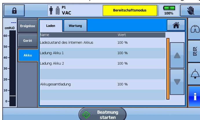
Sie sollten den Ladezustand des internen Akkus sowie ggf. angeschlossener externer Akkus regelmäßig prüfen. Es wird empfohlen, Akkus grundsätzlich nach 400 Ladezyklen auszutauschen.
