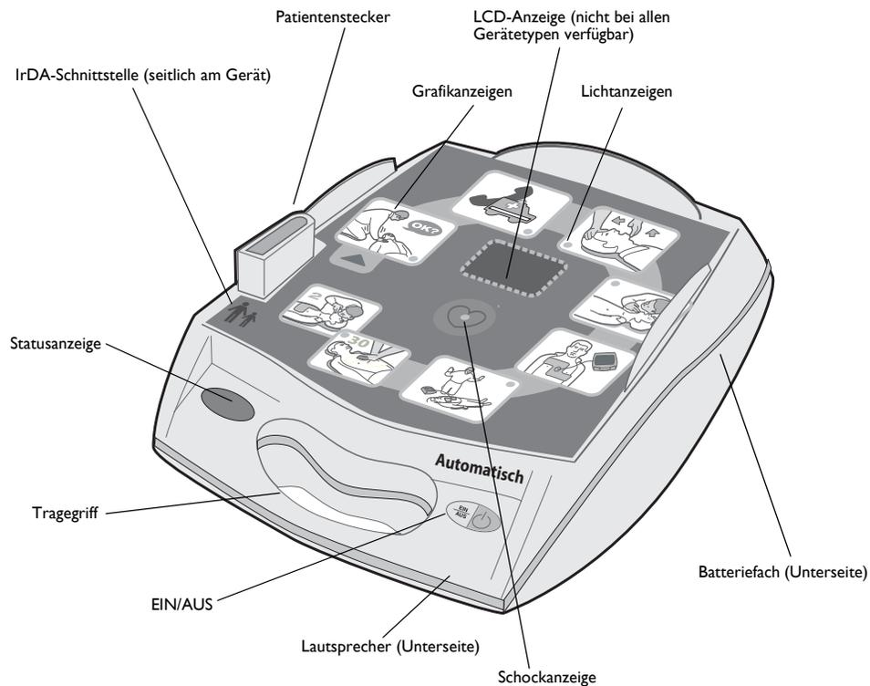
Abbildung 1: Position der Bedienelemente und Anzeigen am Gerät
