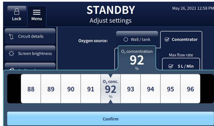
Abbildung 11: **Konzentrator** – Auswahlleiste zum Ändern der Sauerstoffkonzentration
