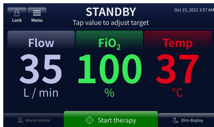
Abbildung 50: Geöffneter Bildschirm, um Flow, FiO<sub>2</sub> oder Temperatureinstellungen zu ändern
