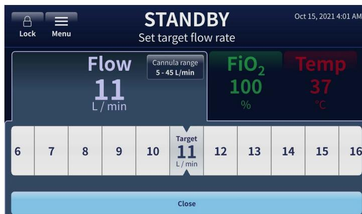
Abbildung 63: Einstellung des Parameters Ziel-Flow-Rate
