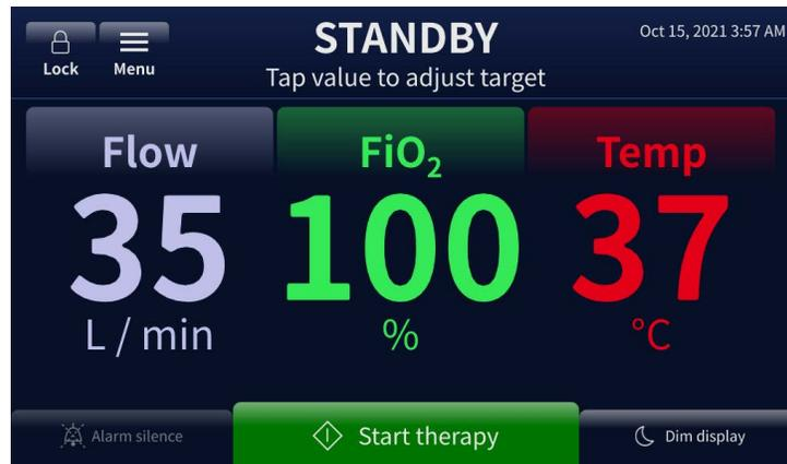
Abbildung 62: Geöffneter Bildschirm, um Flow, FiO<sub>2</sub> oder Temperatureinstellungen zu ändern
