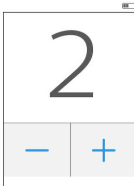
2. Drücken Sie die Schaltflächen + oder -, um die O<sub>2</sub>-Einstellung wie gewünscht zu erhöhen oder zu reduzieren. Sie können die Einstellung in 1er-Schritten von 1 bis 5 anpassen.
